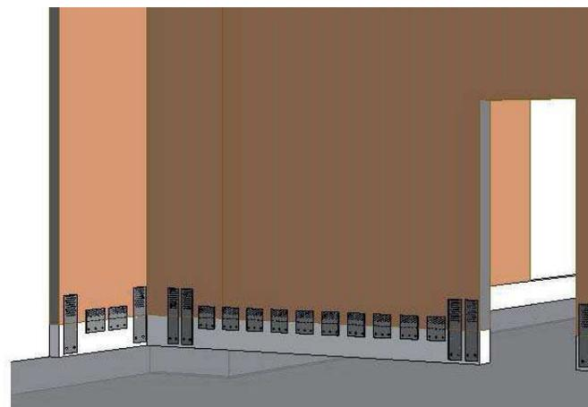
Ampliamento B | Vista tridimensionale da modello BIM (collegamenti XLAM)
