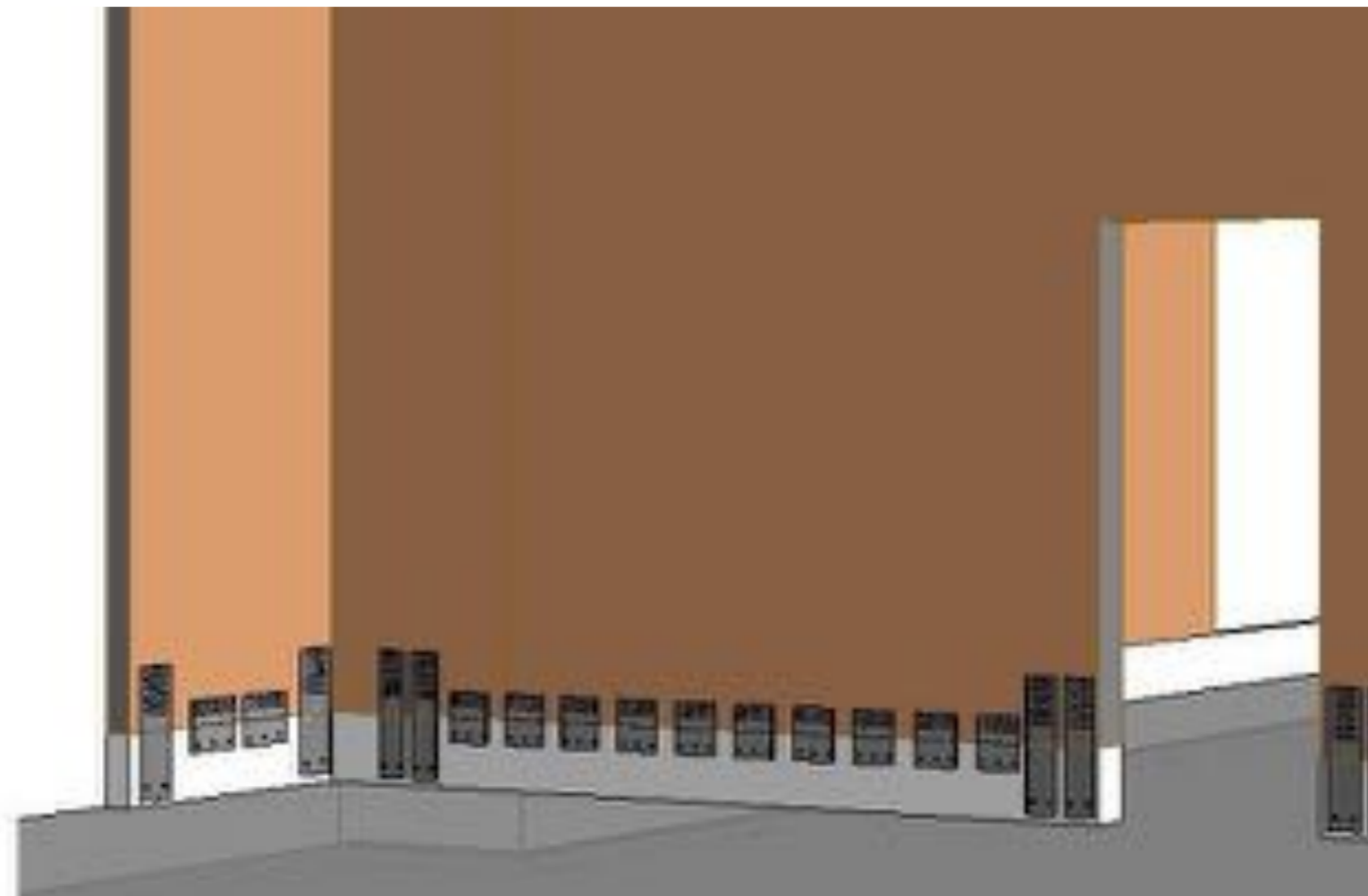
Ampliamento B | Vista tridimensionale da modello BIM (collegamenti XLAM)
